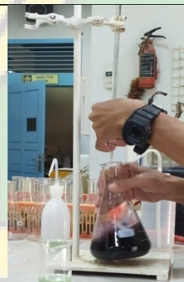
Gambar 6. Dititrasi dengan FeSO_4
