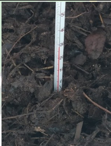
Gambar 18. Proses pengukuran suhu selama pengomposan
