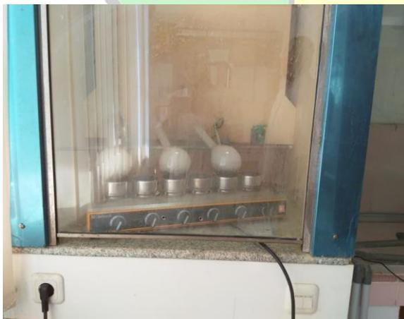
Diletakkan dalam lemari asam untuk proses destruksi
