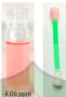
Gambar 16. Deteksi Pb(II) pada limbah industri menggunakan (a) ekstrak dan (b) kapas pentul berlapis ekstrak
