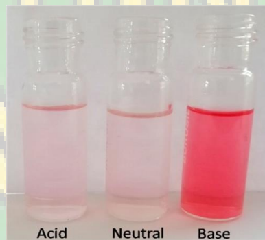
Gambar 4. Pengaruh pH untuk pewarnaan Pb(II) dengan ekstrak
