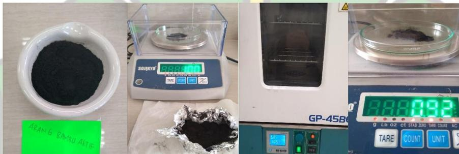
Gambar 23. Hasil uji kadar air setelah proses aktivasi
