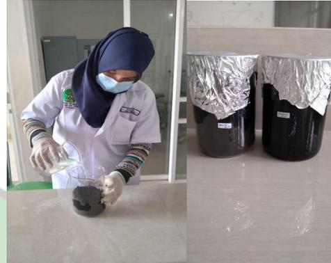
Gambar 6. Perendaman arang dengan  $\text{Na}_2\text{CO}_3$  20%,  $t = 24$  jam
