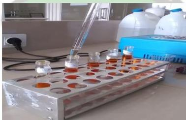
Gambar 19. Proses penambahan  $K_2Cr_2O_7$  dan  $H_2SO_4$
