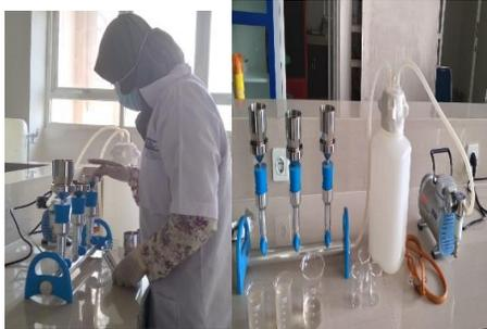
Gambar 16. Penyaringan air limbah dengan pompa vacum
