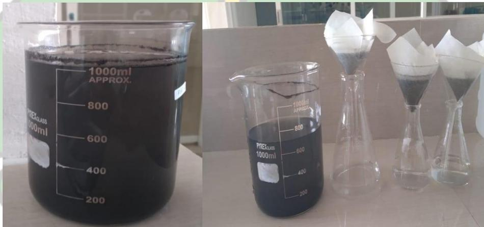
**Gambar 4.6** Sampel air limbah binatu saat proses (a) sedimentasi dan (b) filtrasi
