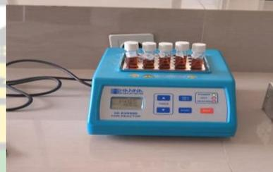
Gambar 20. Proses pemanasan selama 2 jam
