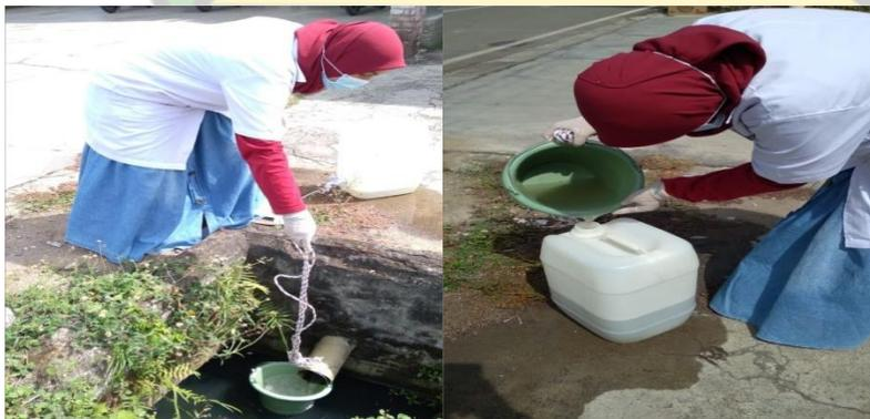
Gambar 4. Pengambilan air limbah binatu pada *Outlat* pembuangan air limbah
