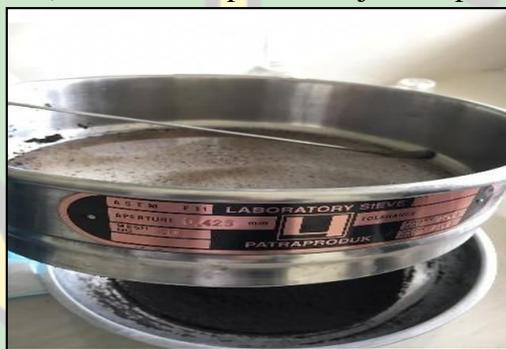
**Gambar 3.18** Ukuran arang aktif yang digunakan pada analisis FTIR
