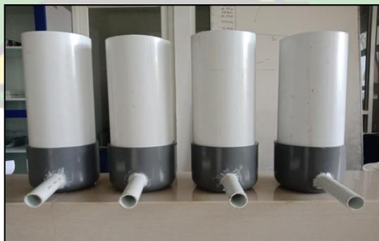
**Gambar 3.28** Alat filtrasi yang terbuat dari pipa PVC
