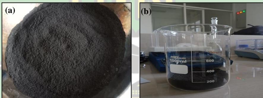
**Gambar 3.11** (a) Arang ditimbang sebanyak 1 kg dan (b) arang dimasukkan ke dalam gelas kimia 1000 ml
