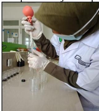
**Gambar 3.19** Peneliti melakukan pengenceran pada larutan standar Fe 1000 ppm
