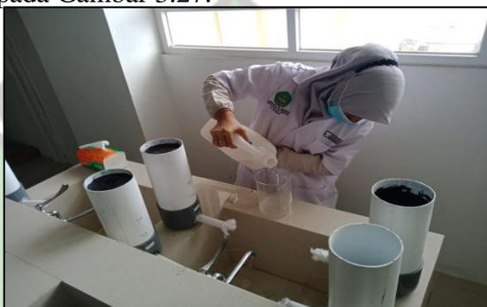
**Gambar 3.27** Peneliti mengolah air sumur dengan metode filtrasi
