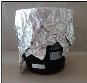
**Gambar 3.13** Arang direndam selama 48 jam dalam gelas kimia dan ditutup dengan *aluminium foil*
