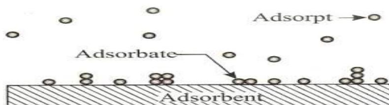
**Gambar 2.1** Proses adsorpsi Adsorbat oleh Adsorben (Bird, 1993)
