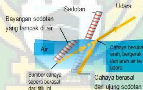
**Gambar 5 :** Proses Pembiasan Pada Sedotan
