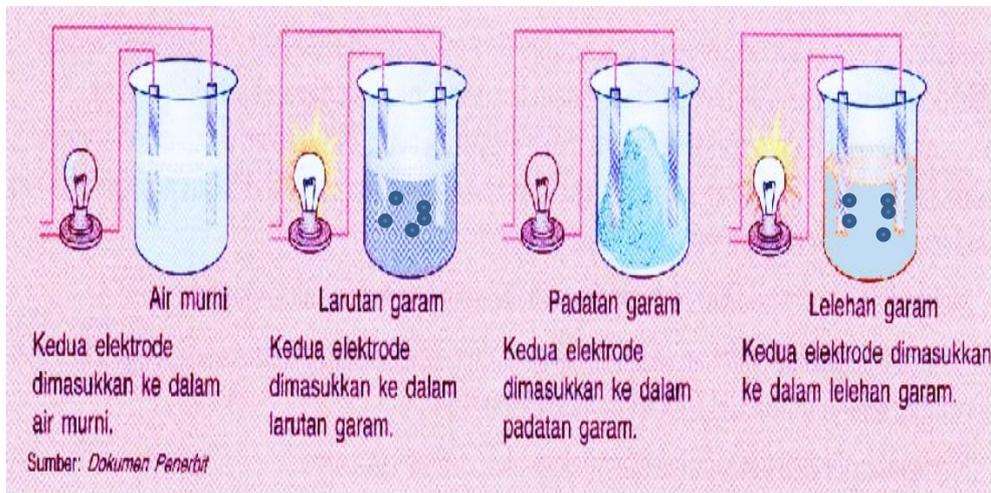
Berdasarkan gambar di atas, ketika elektroda positif dan negatif dicelupkan ke dalam air murni dan padatan garam tidak mampu menyalakan lampu, sedangkan ketika elektroda positif dan negatif dicelupkan ke dalam larutan garam dan lelehan garam mampu menyalakan lampu, rumuskan peristiwa yang terjadi di dalam tabung yang berisi padatan garam, air murni, lelehan garam, dan larutan garam sehingga berpengaruh ke nyala lampu!
