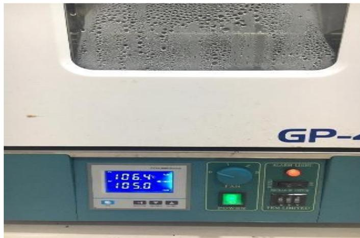
**Gambar 3.5** Ampas kopi di oven 105°C selama 2 jam.
