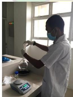
Pembuatan larutan standar HCl 0,1 M
