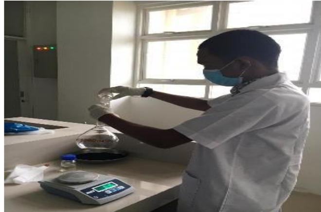
**Gambar 3.9** Pembuatan larutan standar Fe di dalam labu ukur ukuran 1000 ml.
