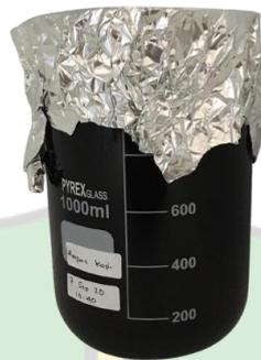
**Gambar 3.3** Ampas kopi direndam HCl 0,1 M di dalam gelas kimia dengan ukuran 1000 ml.
