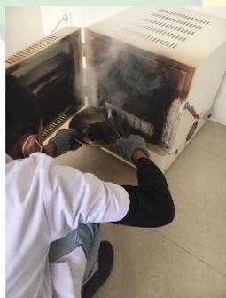
Ampas kopi di *muffle furnace* pada
