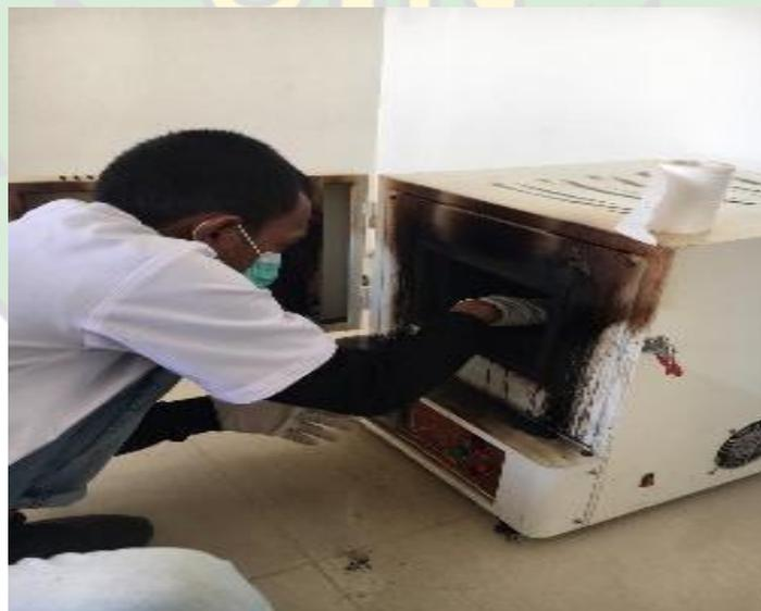
**Gambar 3.6** Peneliti memasukkan ampas kopi ke dalam *muffle furnace* suhu 350°C selama 3,5 jam.
