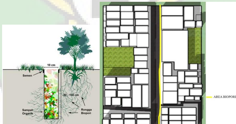
Gambar 4.33 : Lubang Biopori dan penempatannya Sumber : Dinolefty.wordpress.com dan Analisa pribadi
