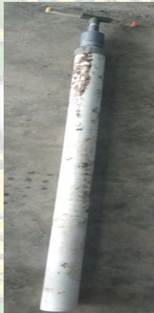
**Gambar 3.3.** Alat pengambilan sampel sedimen menggunakan pipa paralon
