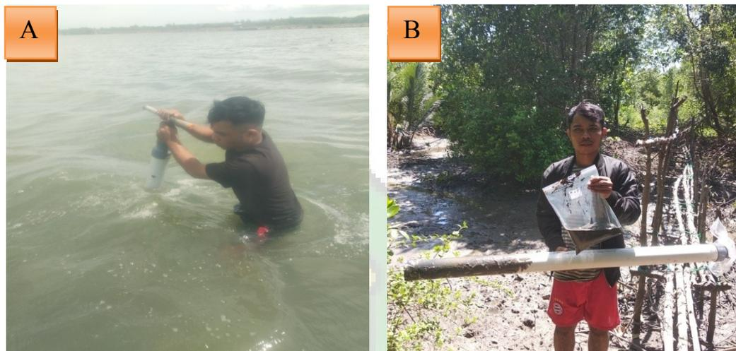
**Gambar 3.4** (a) Tahapan pengambilan sedimen, (b) Sampel sedimen dikemas.
