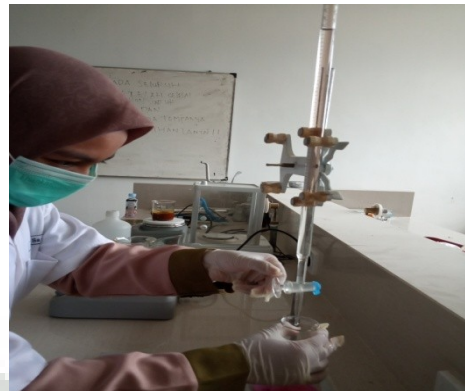
Gambar 28. Titrasi dengan NaOH 0,25 M
