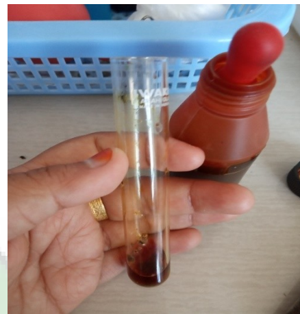
Gambar 16. Hasil Uji Iodin Selulosa
