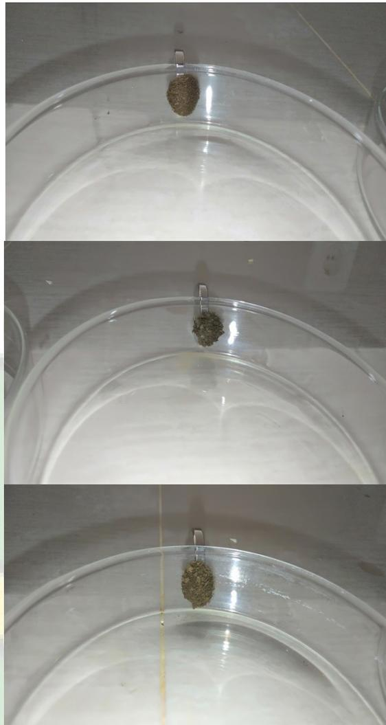
**Gambar 4.5.** padatan hasil pembuatan magnetit ketika didekatkan dengan medan magnet bagian luar.
