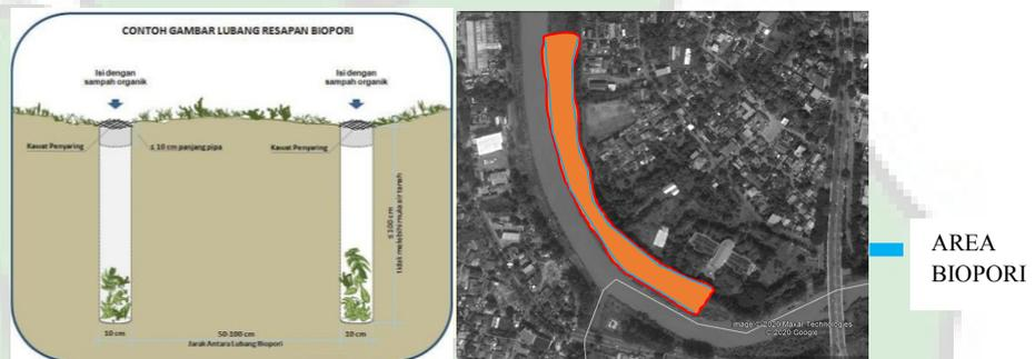
Gambar 37: Lubang biopori dan penempatannya
