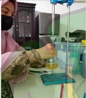
11. Dititrasi dengan  $\text{Na}_2\text{S}_2\text{O}_3$
