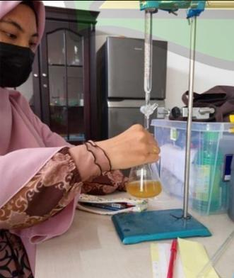
11. Campuran dititrasi dengan  $\text{Na}_2\text{S}_2\text{O}_3$
