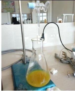
9. Dititrasi dengan NaOH 0,05 M
