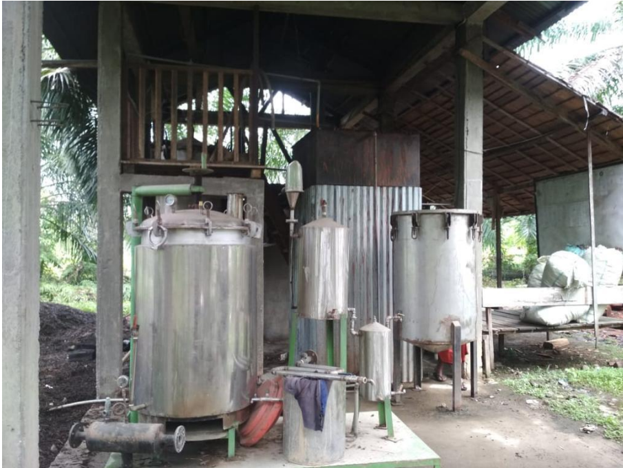
Alat penyulingan nilam untuk menghasilkan minyak nilam
