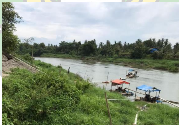
Gambar 2 : Daerah Aliran Sungai yang terdapat alat sedot untuk menambang bahan galian mineral bukan logam dan batuan di Kecamatan Kutablang Kabupaten Bireuen.
