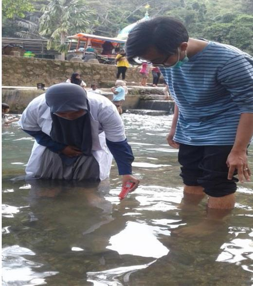
Gambar 1. Pengukuran pH dan Suhu
