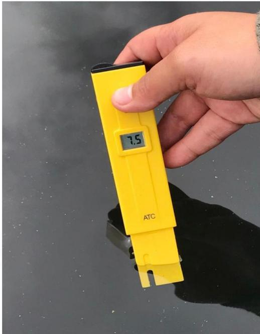
Gambar 5. Pengukuran pH
