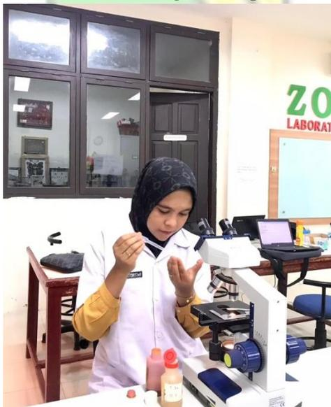
Gambar 7. Peletakan Sampel dan Penetesan Lugol pada Sampel
