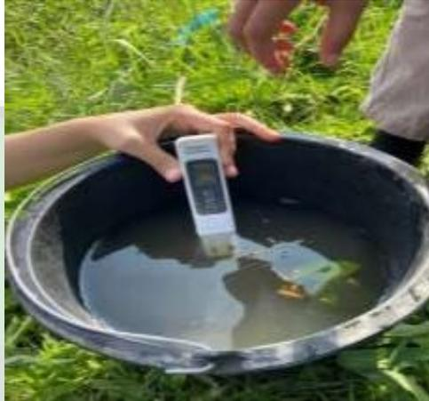
Gambar 2. pengukuran suhu air
