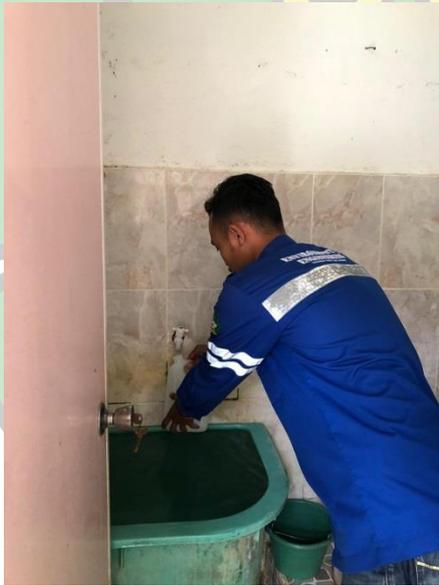
C.7. Pengambilan sampel air produksi untuk di uji lab
