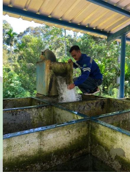
C.6. Pengambilan sampel air baku untuk di uji lab
