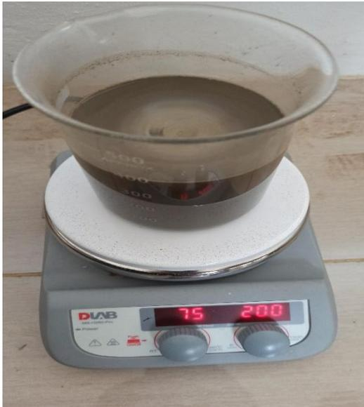
Proses pengadukan sampel dengan *magnetik stirer* pada suhu  $75^{\circ}\text{C}$  dengan 200 RPM.
