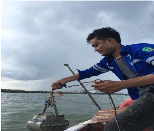
Proses pengambilan sampel sedimen Sungai krueng Aceh dengan Alat *Sediment grabber*.
