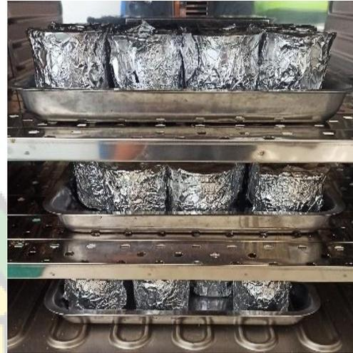
Sampel sedimen Sungai Krueng Aceh di oven pada suhu 90<sup>0</sup>c selama 24 jam.
