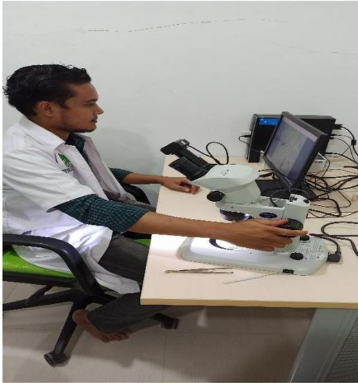
Proses menghitung dan identifikasi mikroplastik dengan alat mikroskop binokuler.
