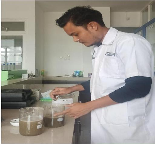
Proses penarikan partikel magnetik dalam sampel sedimen ekstraksi dengan menggunakan besi magnetik.
