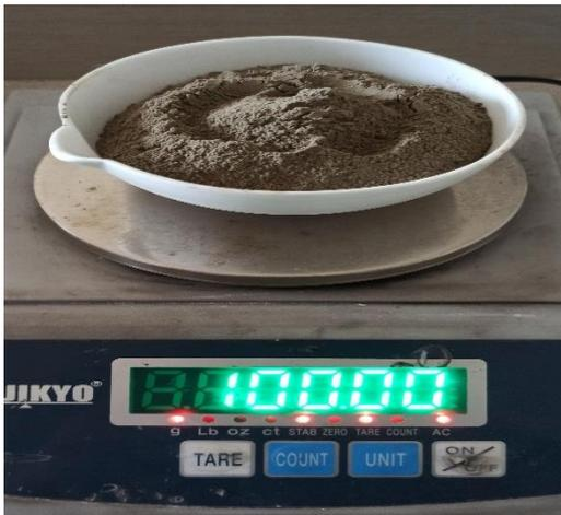
Proses penimbangan sampel sedimen yang lolos ayakan dengan neraca analitik.
