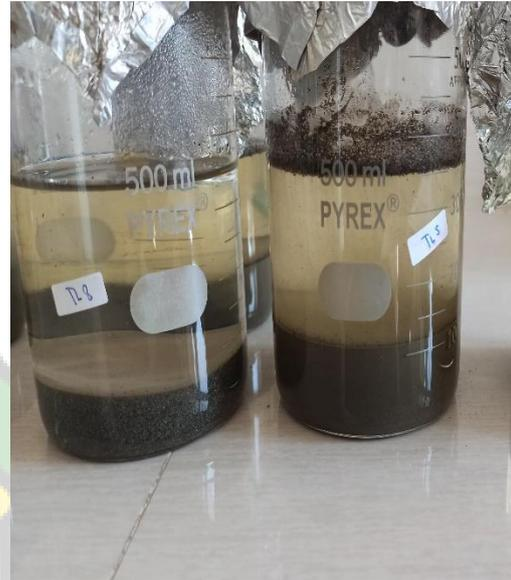
Sampel-sampel sedimen yang didiamkan selama 48 jam.
