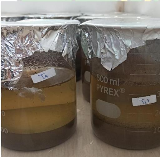
Proses didiamkan sampel dengan NaCl selama 24 jam.
