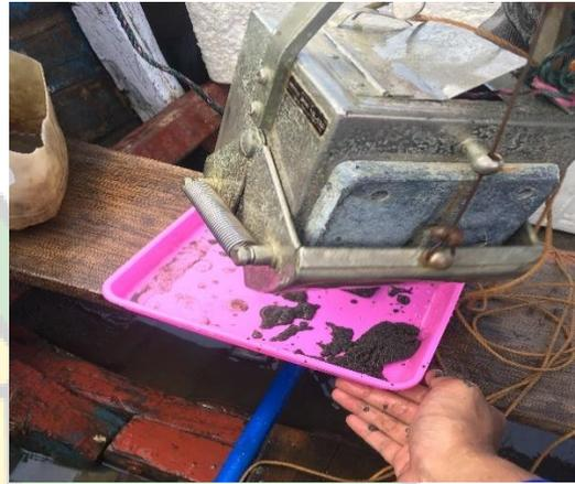
Proses pengambilan sampel sedimen Sungai Krueng Aceh dalam alat *sediment grabber*.
