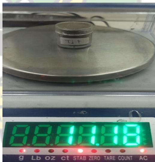
Sampel sedimen yang lolos ayakan dimasukkan dalam *holder* untuk pengukuran suseptibilitas magnetik.
