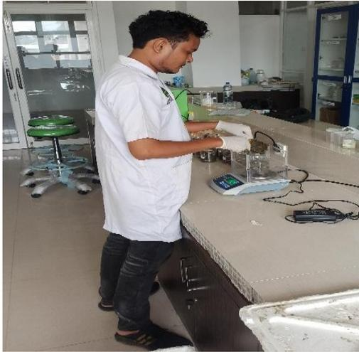
Proses penimbangan sampel sedimen basah dengan neraca analitik.
