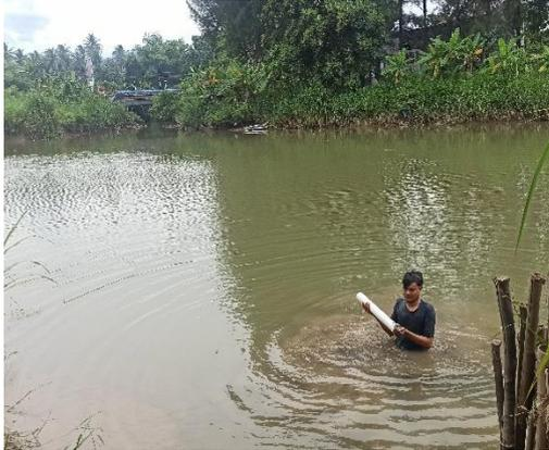
Proses pengambilan sampel sedimen Sungai Krueng Aceh dengan pipa PVC.
