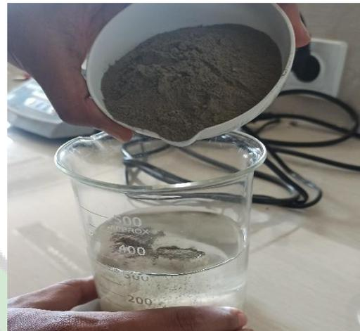
Sampel sedimen dimasukkan ke dalam *beaker glass* yang sudah terisi NaCl.
