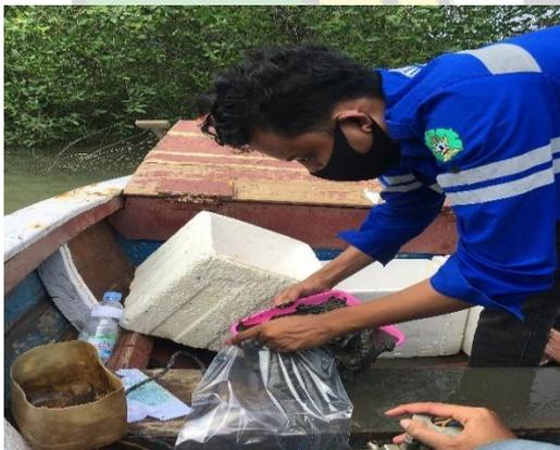
Proses sampel sedimen Sungai Krueng Aceh dimasukkan kedalam kemasan plastik dan dilakukan pelabelan.
