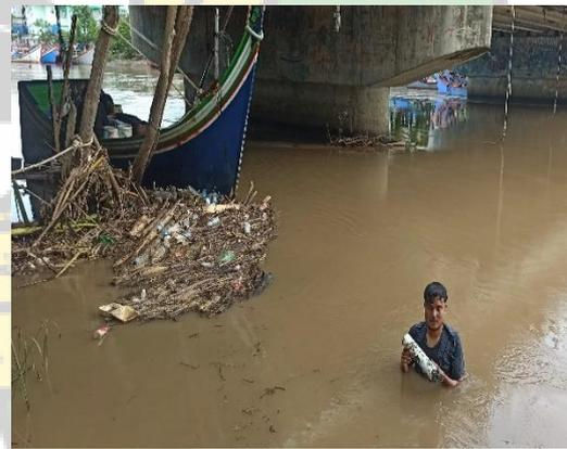
Proses pengambilan sampel sedimen Sungai Krueng Aceh dengan pipa PVC.
