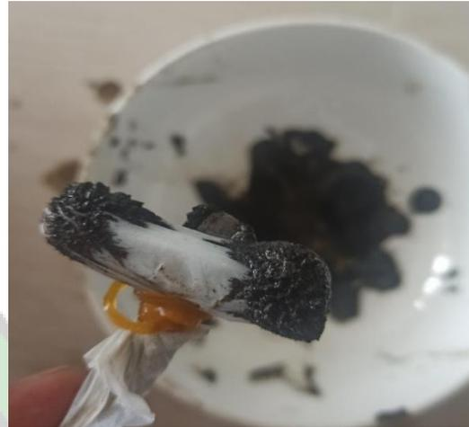
Partikel-partikel magnetik yang menempel pada besi magnet dan dikumpulkan untuk pengukuran XRD.
