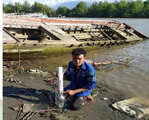
Proses pengambilan sampel sedimen dari pipa PVC, dimasukkan ke dalam kemasan plastik.
