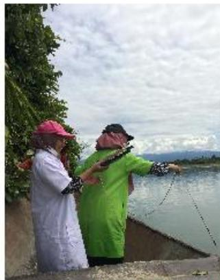
Gambar 4 : Mengukur kedalaman menggunakan secci disk
