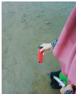
Gambar 7 : Mengukur kadar keasamaan suhu air menggunakan PH meter
