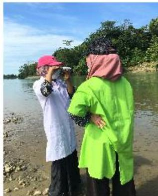
Gambar 6 : Mengukur kadar salinitas menggunakan Refraktometer
