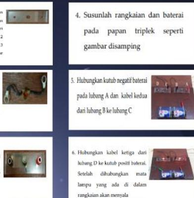
Gambar 4.6. Cara Pembuatan Rangkaian Seri
