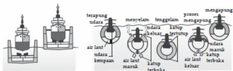
Gambar 7.6 (a) Galangan kapal (b) Prinsip mengapung dan tenggelam pada sebuah kapal selam.
