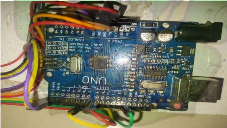
**Gambar 4.1** Rangkain *Input* Dan *Output* Yang Terhubung Ke *Arduino Uno*
