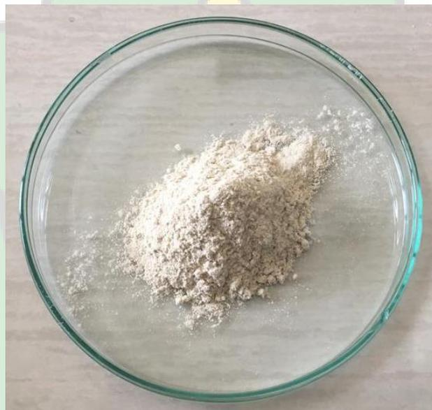
**Gambar 4.1.** Serbuk sintesis nanopartikel  $\text{TiO}_2\text{-SiO}_2$
