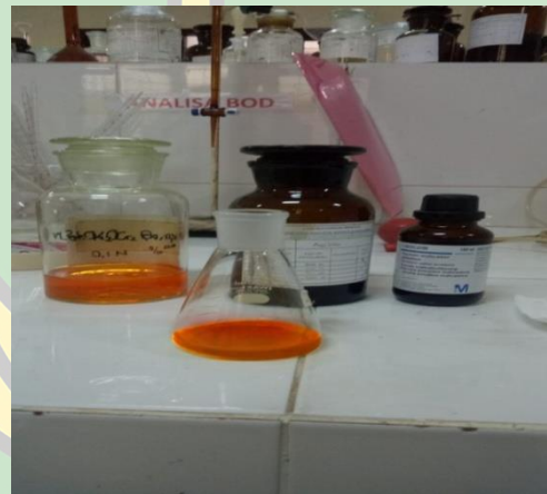
Sampel yang telah mencapai titik akhir titrasi, ditandai dengan terjadinya perubahan warna menjadi merah kecoklatan
