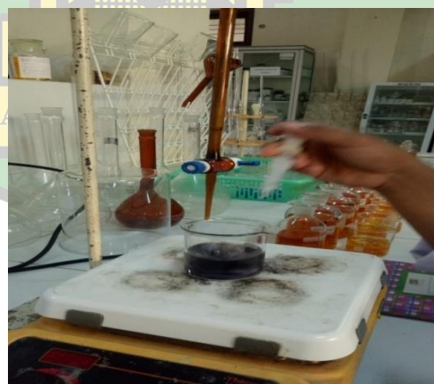
Sampel yang telah ditambahkan amilum berubah warna menjadi biru
