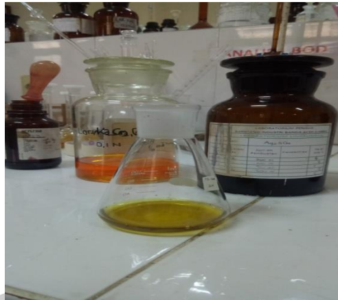
Sampel dipanaskan pada suhu 150^{\circ}\text{C} dan digestion 2jam
