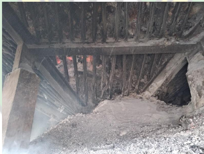
Gambar 2. 2 Abu Hasil Pembakaran Tandan Kosong Di Dalam Insinerator
