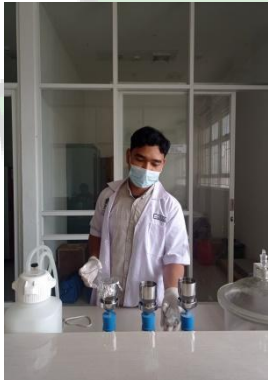
Gambar 2.4 Proses pengukuran TSS dengan vakum filtrasi
