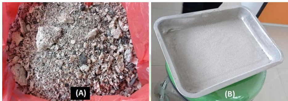
Gambar 4. 1 (a) POFA sebelum disaring dan (b) POFA setelah disaring
