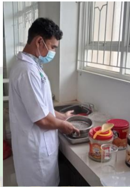
Gambar 1.2 penyaringan POFA 10 mesh
