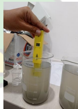
Gambar 3.18 Hasil Pengujian pH 25g 30 menit
