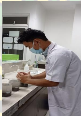
Gambar 1.5 Perendaman POFA dengan Larutan \text{NH}_4\text{Cl}
