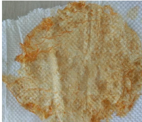
Gambar 9. Membran Kitosan PEG 7% (v/v) Setelah Penyerapan Fe(III)
