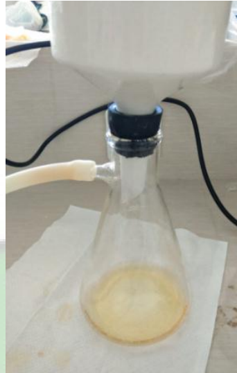
Gambar 4. Proses penyerapan logam Fe(III) dengan membran kitosan PEG 5%, 7% dan 9% (v/v)
