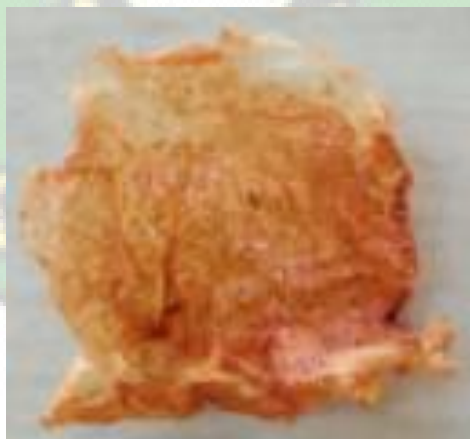
Gambar 8. Membran Kitosan PEG 5% (v/v) Setelah Penyerapan Fe(III)
