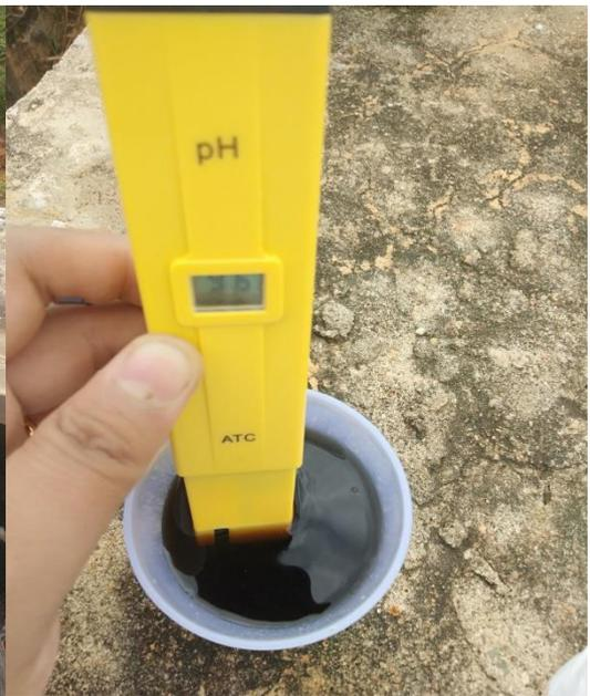
**Pengukuran pH Pada Air Tanah**
