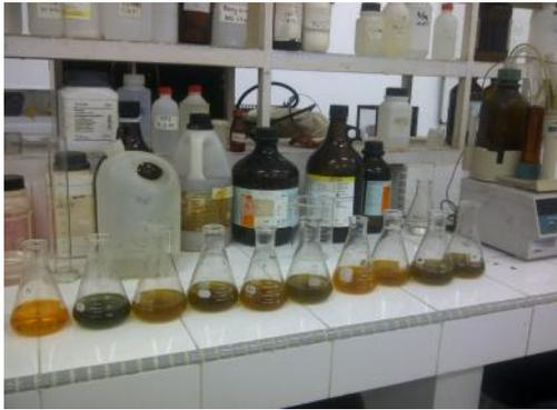
Gambar 25. Persiapan sampel sebelum dititrasi dan telah dicampur larutan
