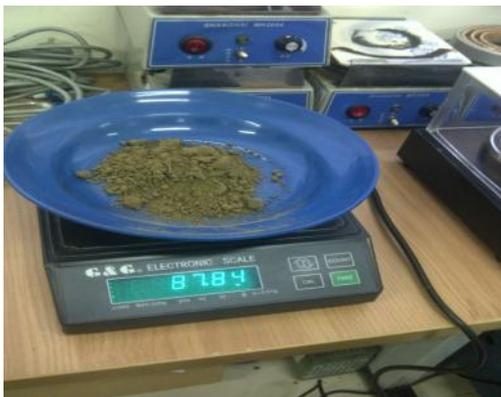
Gambar 17. Hasil berat kering sub sampel setelah ditimbang
