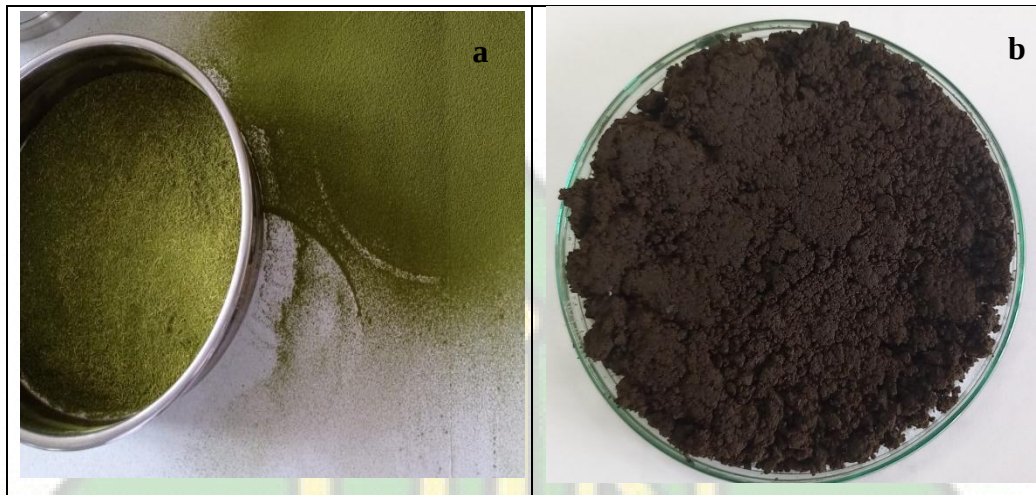
Gambar 4.1 penampakan fisik serbuk daun trembesi ayakan 100 mesh. a) sebelum dijadikan arang aktif, b) setelah dijadikan arang aktif.
