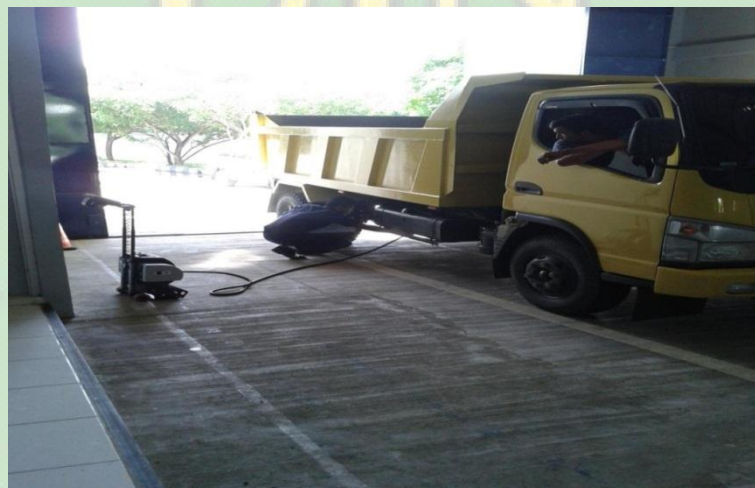
Gambar 3.5 Proses pengujian polutan CO dan CO 2 di UPTD PKB Dishub Kota Banda Aceh (Sumber : UPTD PKB profil pengujian)
