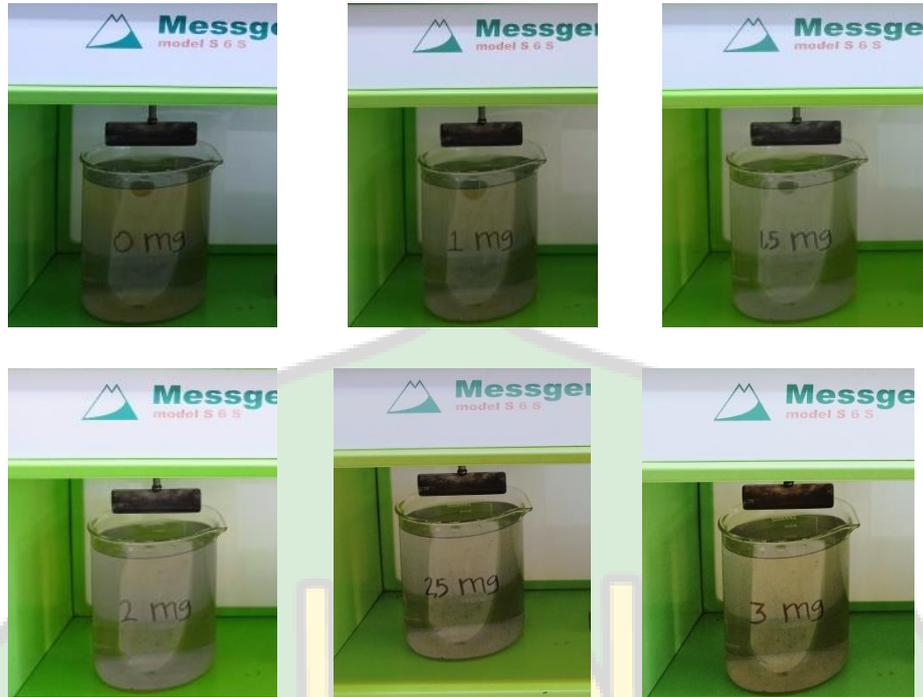
Gambar Sampel Air Limbah setelah Proses Pengendapan Selama 30 menit
