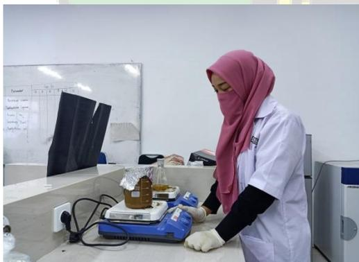
Gambar Pemanasan dan Pengadukan setelah Penambahan Larutan NaOH 50 %
