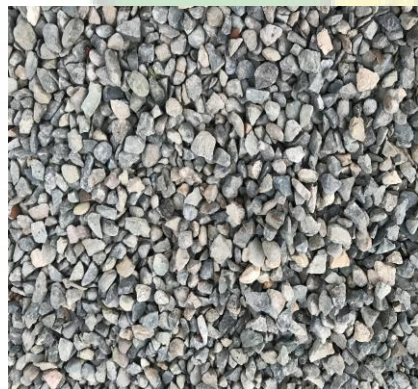
Media kerikil yang digunakan dalam unit filter
