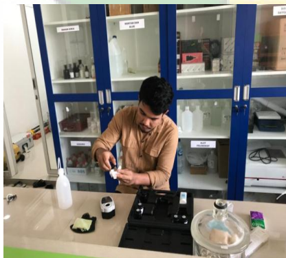
Proses pengukuran parameter kekeruhan.
