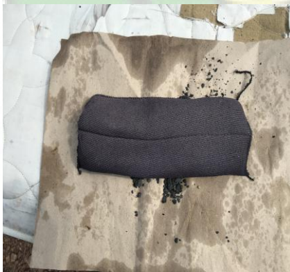
Media arang aktif yang digunakan dalam unit filter
