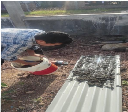
Proses pengeringan media serabut ijuk yang telah dibersihkan
