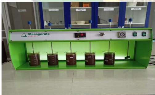
Proses pengadukan dengan kecepatan pengadukan cepat 180 rpm dan pengadukan lambat 80 rpm
