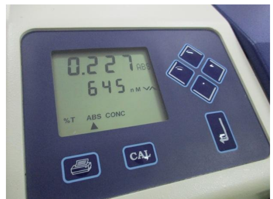
Gambar 42. Melihat kandungan klorofil pada gelombang 645 nm pada spektrofotometer Jenway 6300
