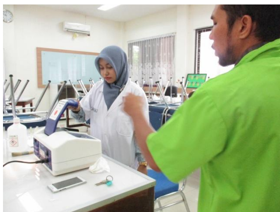
Gambar 41. Mengukur kadar klorofil dengan spektrofotometer Jenway 6300
