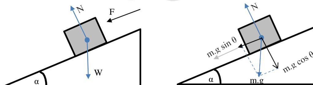
Gambar 2. 5 gerak benda pada bidang miring
