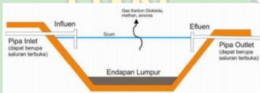
Gambar 2.1 Ilustrasi Pengolahan pada Kolam Anaerobik
