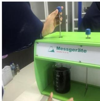
**Gambar 1.8** proses pengadukan adsorben menggunakan jar test
