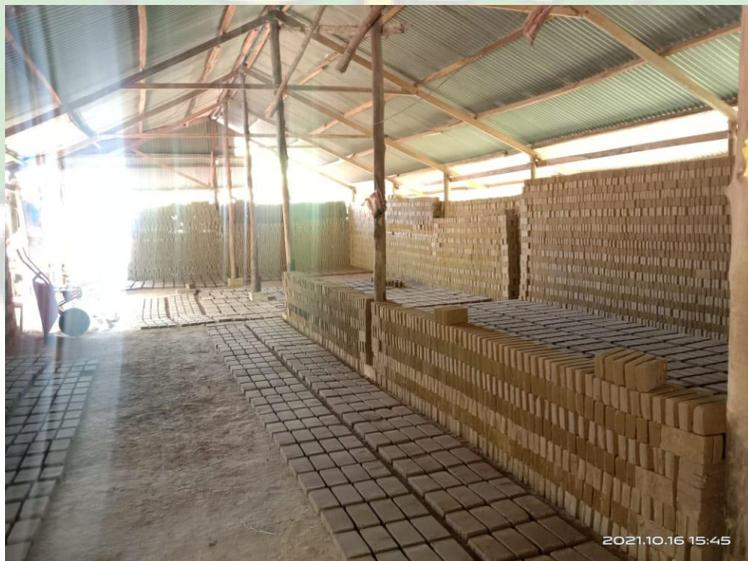
Gambar 8 Batu bata yang baru di cetak
