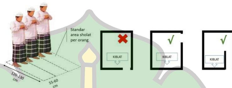
Gambar 2.15 Ilustrasi Penerapan Standar Dimensi Ruang Salat Per Orang dan Penentuan Peletakan Pintu Masuk Masjid dan Mushalla
