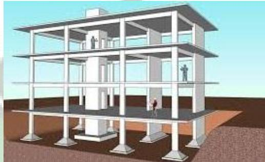
Gambar : Stuktur Rangka
