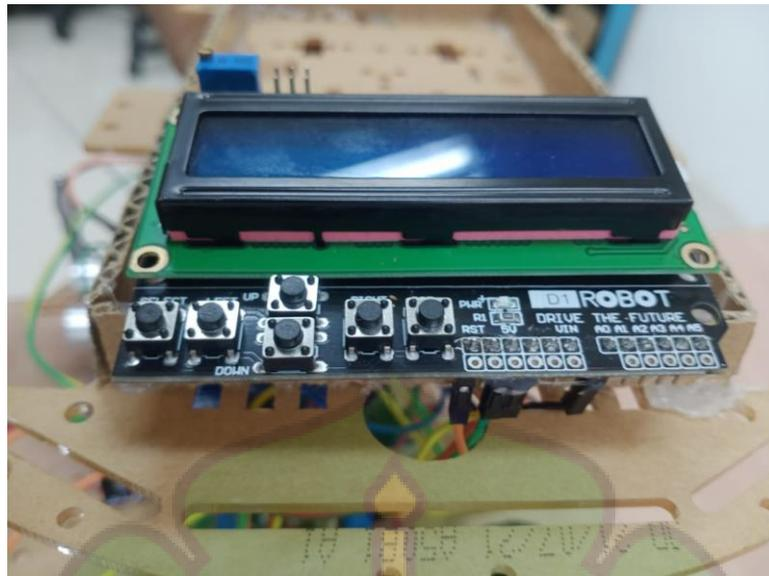
Gambar 4.5 : Rangkaian LCD Keypad Shield
