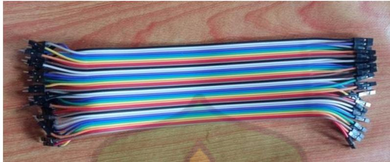
Gambar 2.9 : Kabel Jumper
