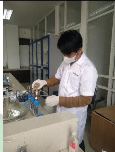
Proses penyaringan air limbah dengan menggunakan pompa vakum
