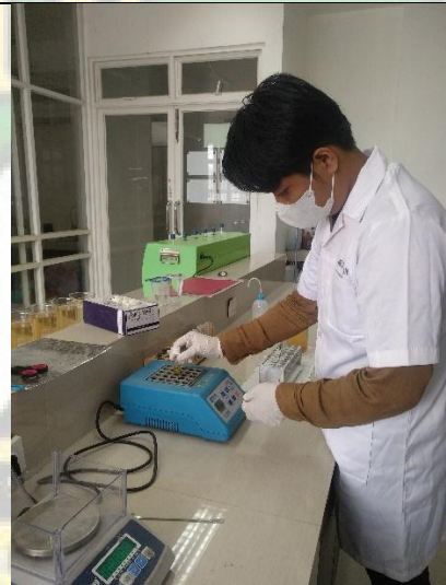
Proses pemanasan sampel uji pada COD reactor
