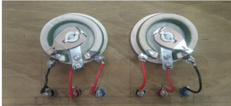
Gambar 4.5 Tampilan Potensio dan *Banana Jack* dari bagian dalam
