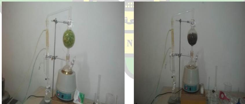
**Gambar 5.3** Proses ekstraksi minyak atsiri kenanga dengan destilasi air dan uap
