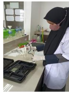
Pengujian Kadar pH pada Sampel Limbah Cair RPH Setelah perlakuan Jar test
