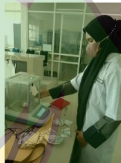
Proses penimbangan kertas saring TSS menggunakan timbangan analitik
