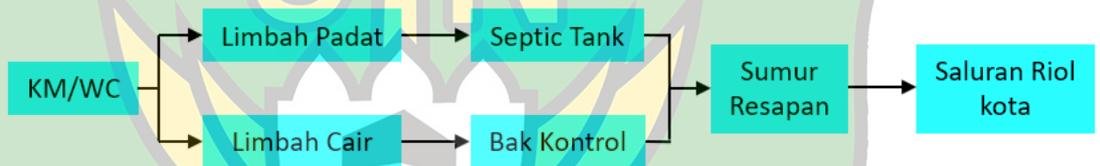
Gambar 5.17 Skema Pembuangan Air Kotor dari KM/WC
