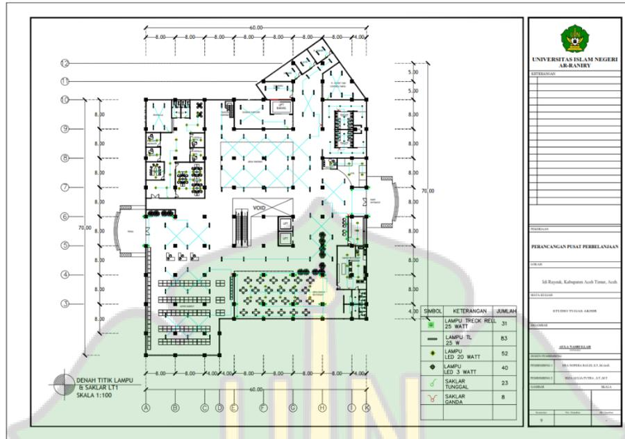
Gambar 6. 44 Denah Rencana Titik Lampu Dan Listrik Lantai 1
